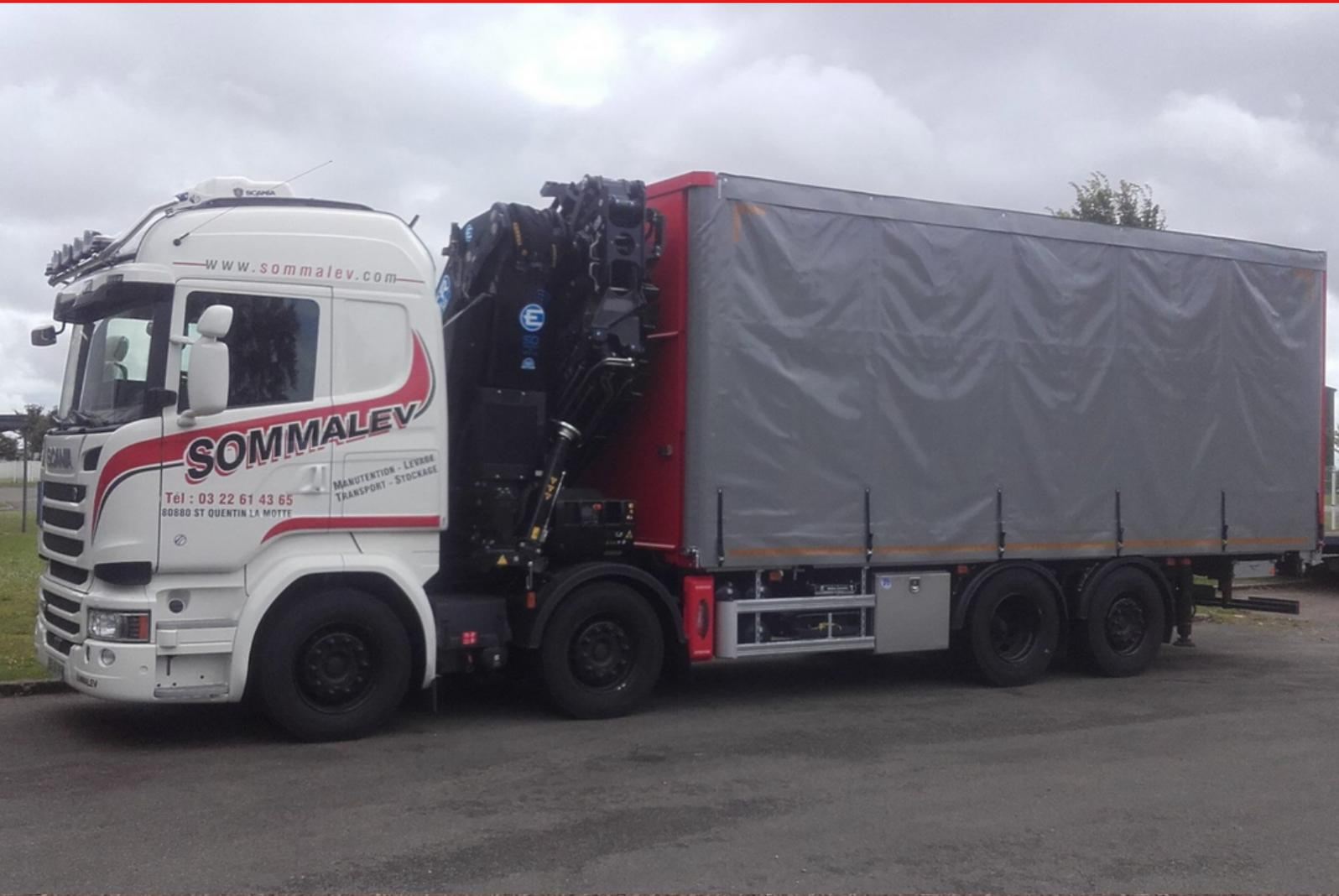
**SCANIA, grue auxiliaire
