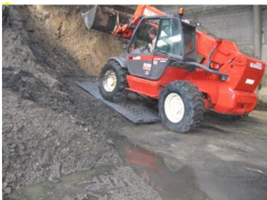
Les plaques de répartition sont parfaites pour la mise en place d'accès temporaires et de plateformes provisoires.
